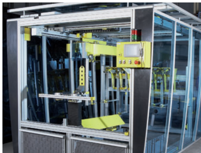
Для изготовления EPS - негативных вставок водоводов, необходимых для производства Perfect- колец с днищем, используются пилы с горячей проволокой
